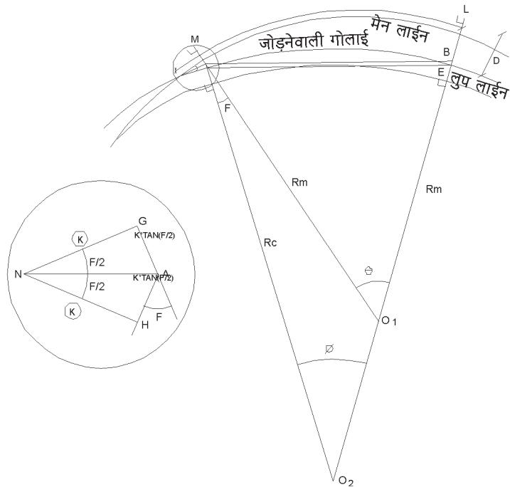
**चित्र 3.13 - गोलाईयुक्त मैन लाईन से 1:12 टर्न आउट द्वारा अंदर के तरफ समानान्तर लूप लाईन का कनेक्शन**
