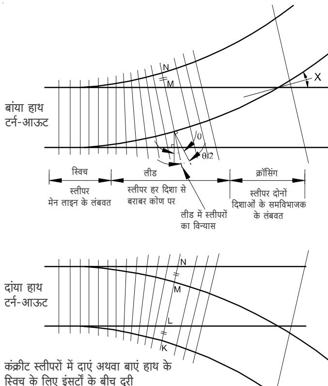
चित्र 7.1 - कंक्रीट स्लीपर युक्त टर्नआउटों पर स्लीपरों की स्थिति
