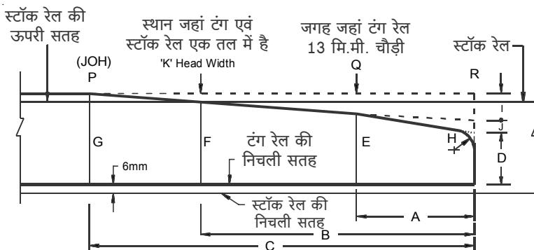
चित्र 2.8 टंग रेल की घिसाई (machining) का रेखाचित्र
