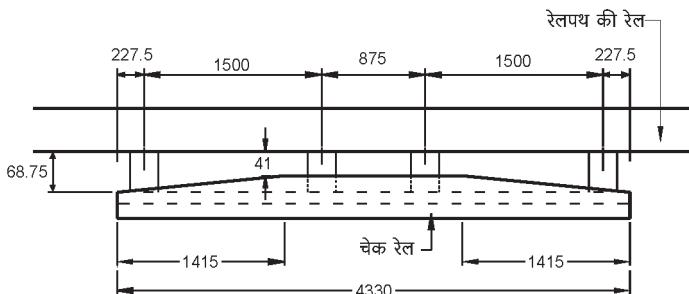
चित्र 3.7 कंक्रीट स्लीपर युक्त टर्नआऊट के लिए चेक रेल
