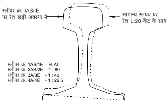
चित्र 3.5 औप्रोच तथा एकजीट स्लीपरों में कैंट
