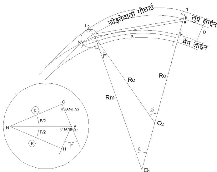
चित्र 3.12 - गोलाईयुक्त मेन लाइन से 1:12 टर्न आऊट द्वारा बाहर की तरफ समानान्तर लूप लाईन का कनेक्शन
