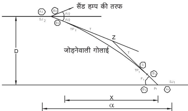
चित्र 3.10 - 1:8 1/2 सिमेट्रीकल स्प्लीट टर्नआऊटसे मेन लाईन पर 1:12 टर्न आऊटसे मेन लाईनपर 1:12 टर्न आऊट तक क्रॉस ओवर
